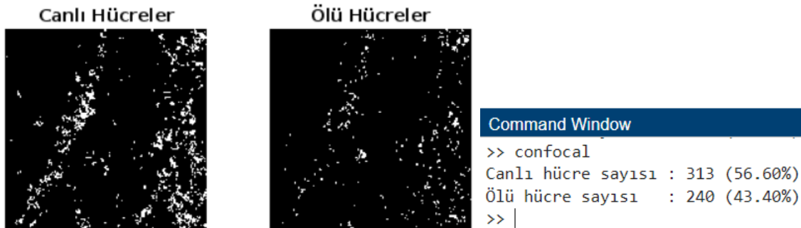
Şekil 4.49 Şekil 4.47 b’de görülen kaplama yüzeylerindeki biyofilmlerin canlı/ ölü hücre analizi (MATLAB’da analiz edilmiştir.)
