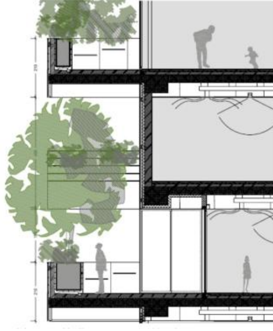
Şekil 4.15. Yeşil balkon Bosco'nun dikey kesiti Dikey [91]
