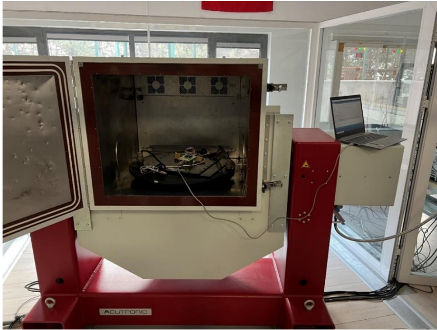
Şekil 11.2: HG9900C1A-2025.2625 ve SDI33.R3.0009 Sensör Yerleşimi
