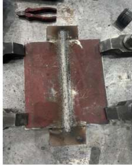
Şekil 6.15. Numune 3 ve 4 için kaynak öncesi ve kaynak sonrası
