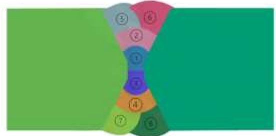
Şekil 6.7. Numune 2 için paso sıralaması
