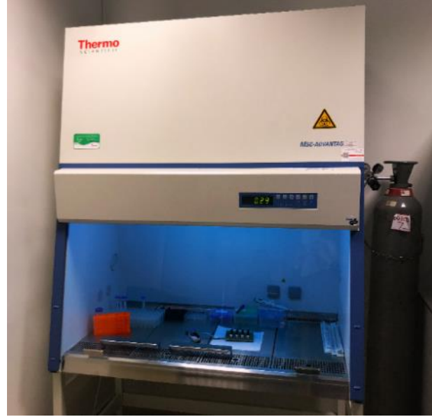
Şekil 3.14. Elektro-kültür plaka sterilizasyonu (Thermo Scientific MSC Advantage Class II, biyolojik güvenlik kabini),
