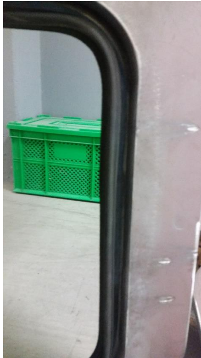
Şekil 7.4. 7.62x51 (AP) mermisinin 8mm zırh boşluğu olan gömme tipi numuneye 15 derece atış açısıyla atış yapıldıktan sonra kapı ve gövde sızdırmazlık contalarında hasar olmadığına gösterimi.
