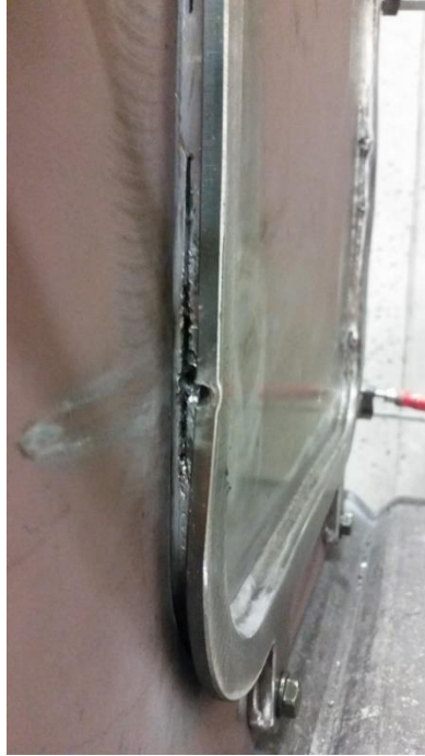
Şekil 7.2. 7.62x51 (AP) mermisinin 8mm zırh boşluğu olan gömme tipi numuneye 15 derece atış açısıyla atış yapıldıktan sonra mermi giriş hasarının gösterimi.
