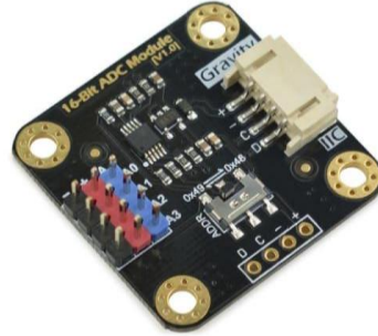
Şekil 4.4. DFRobot ADS1115 ADC [77]
