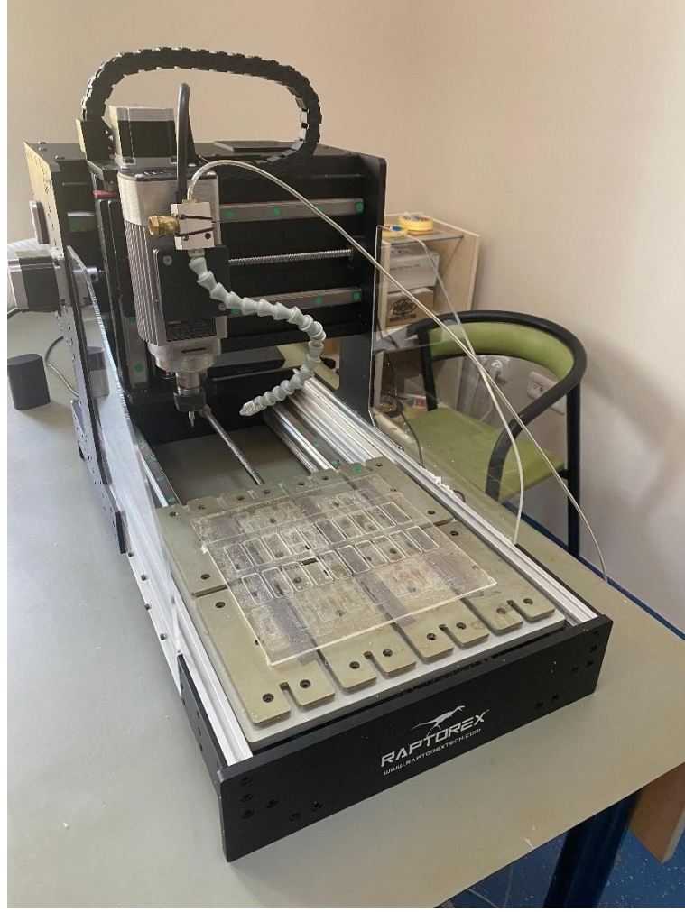
Şekil 4.8. Kullanılan CNC Cihazı ve Kesici Takım
