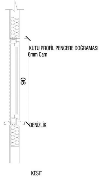
Şekil 5.4. Pencere doğramaları kesit detayı (Kişisel Arşiv).
