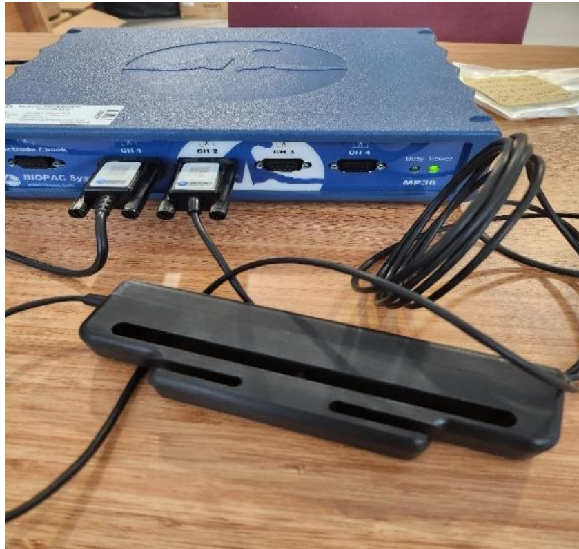
Şekil 3.7. CH2 ara kablosuna bağlı olan clench force
