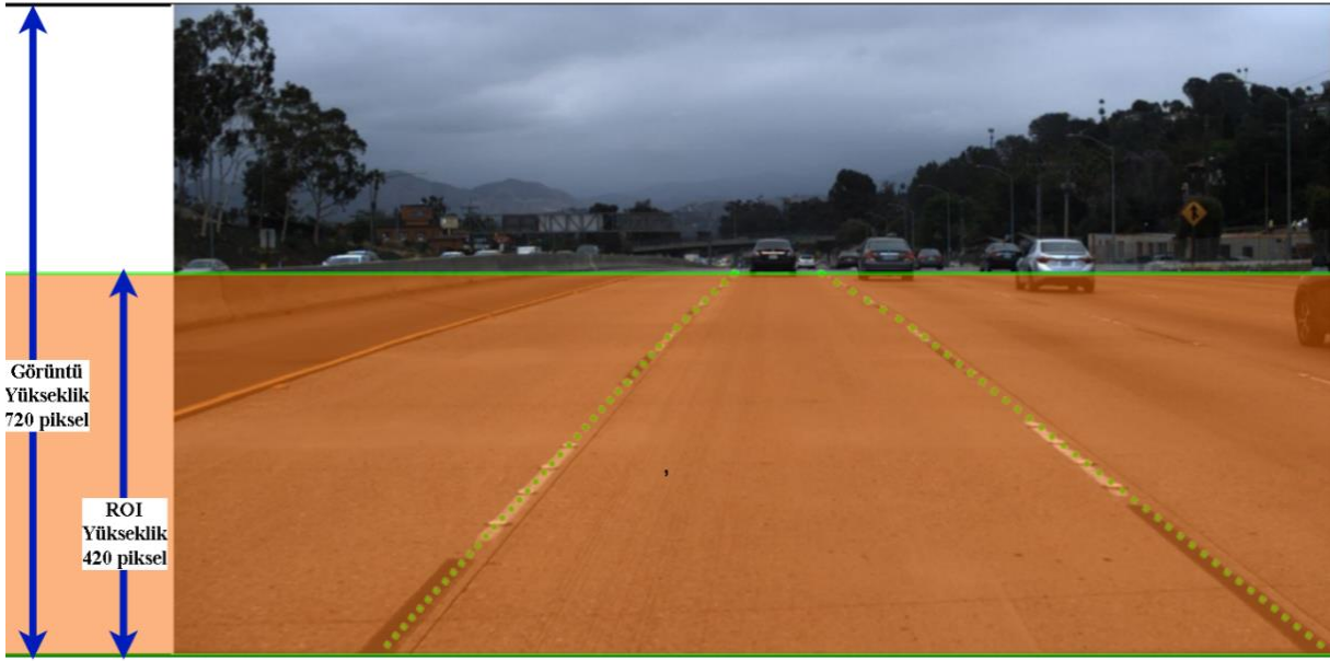
Şekil 0.6 ROI alanının görüntü üzerinde gösterimi
