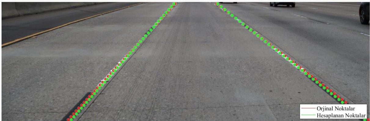
Şekil 0.4 ROI üzerinde orijinal ve hesaplanan noktalar gösterimi
