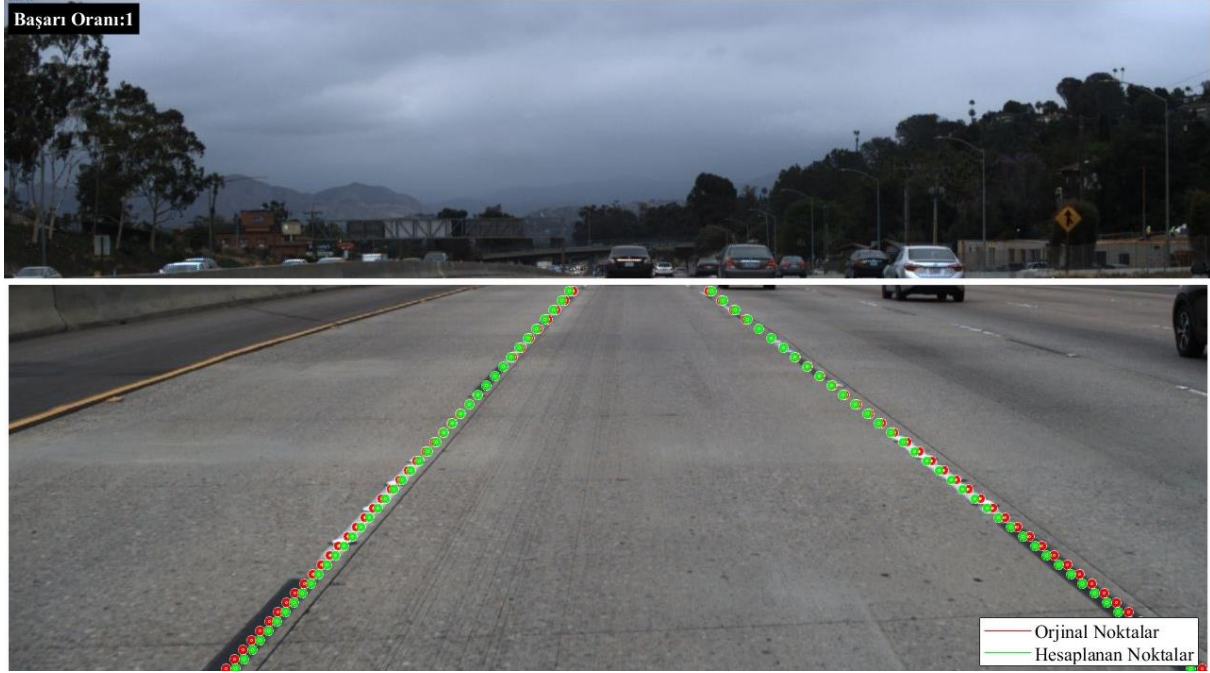
Şekil 0.5 Örnek görüntü üzerinde orijinal noktalar ve hesaplanan noktalar gösterimi
