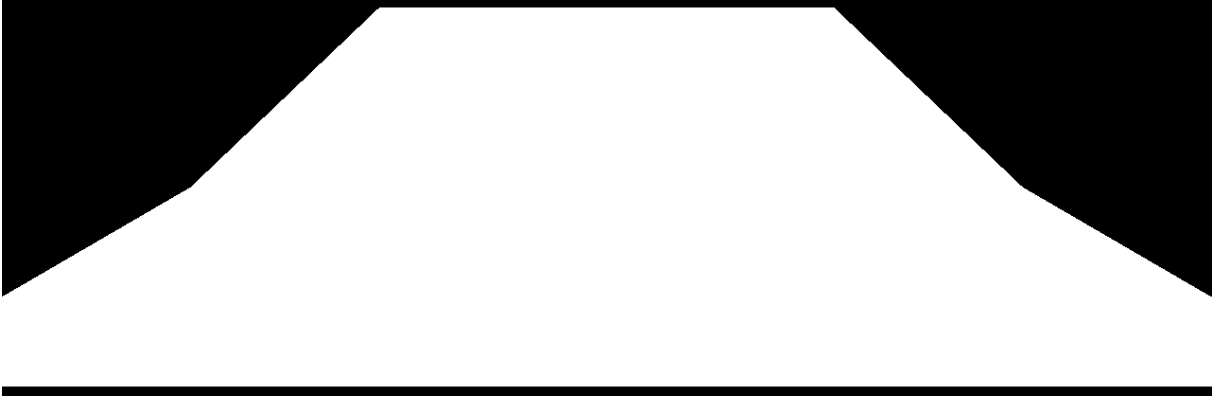
Şekil 0.10 Çalışmada kullanılan yol çizgisi maskeleme görüntüsü
