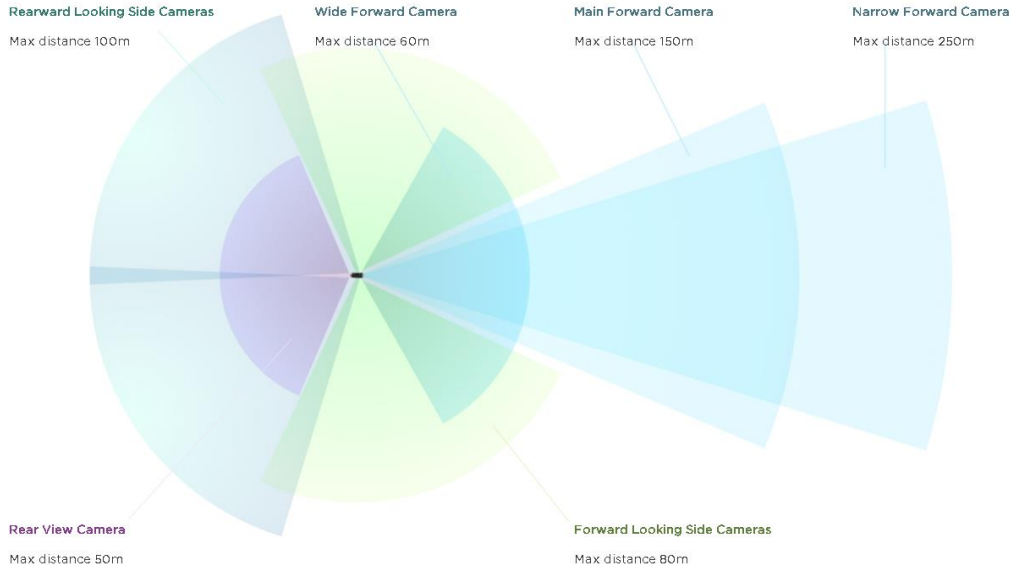
Şekil 0.3 Tesla araçlarda kamera yerleşimi [6]
