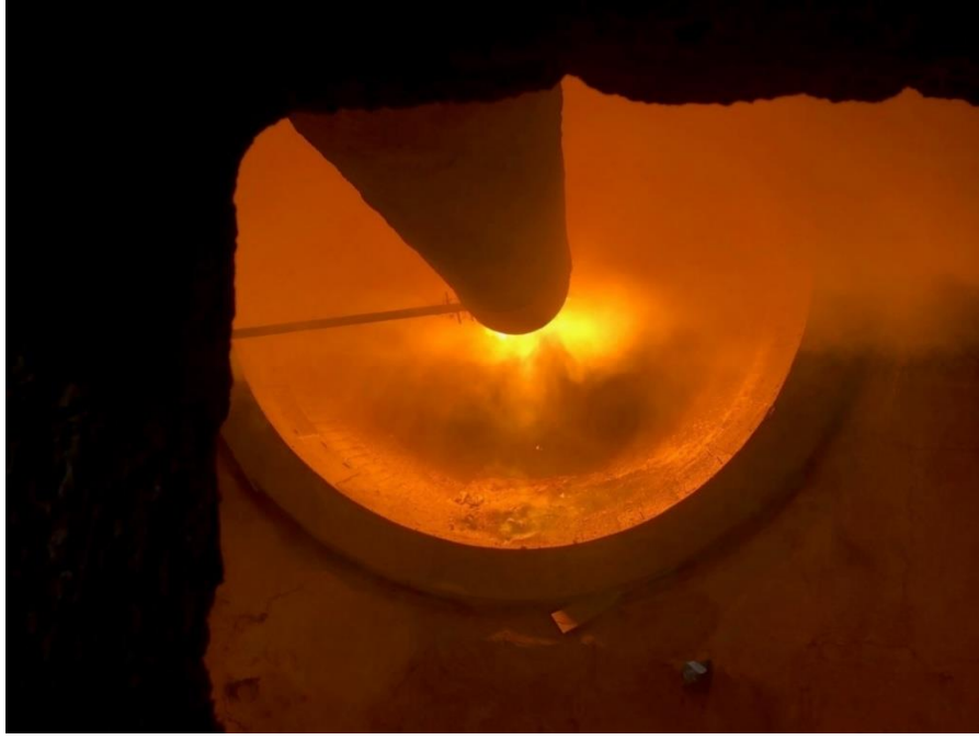
Şekil 3.15. Alev borusu ve ateşleme (yazar tarafından oluşturulmuştur).
