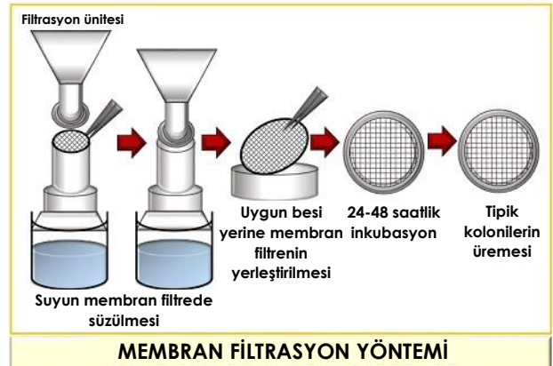
Şekil 8.6. Membran filtrasyon yöntemiyle mikrobiyolojik analiz adımları.
