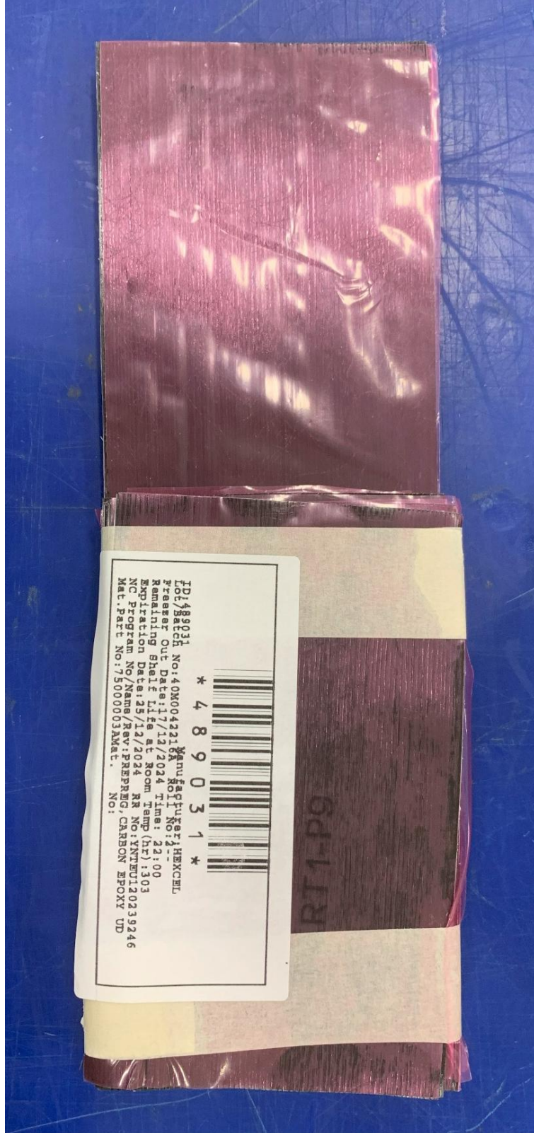
Şekil 4.16. P1, P2 ve P3 test parçaları üretiminde kullanılan AS4/8552 reçine emdirilmiş kumaşlar
