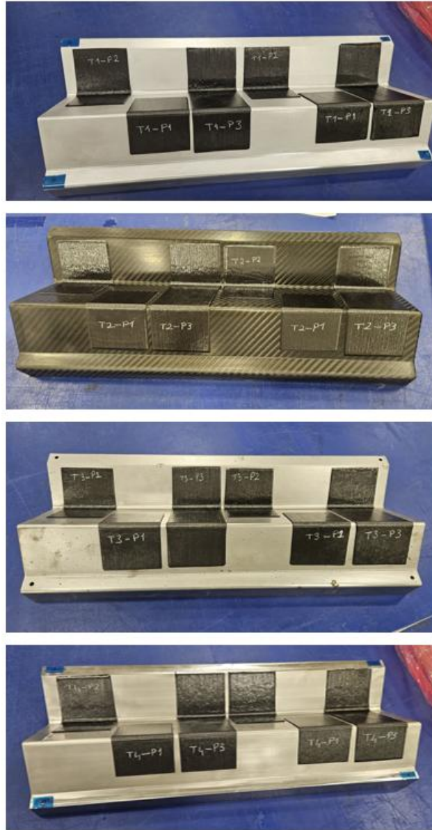
Şekil 4.21. T1, T2, T3 ve T4 kodlu takımlar üzerinde serim işlemleri tamamlanan P1, P2 ve P3 numaralı parçalar
