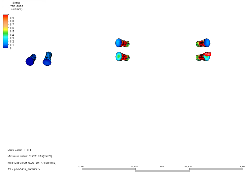
Şekil 4.28. Model 2'deki anterior dik açılı kuvvetlere karşı PEEK fiksasyon vidaları üzerinde oluşan Von Mises Stresler
