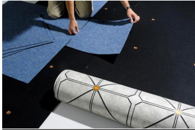
Şekil 2.32. Basıncı algılayabilen piezoelektrik zemin akıllı tekstil örneği.
