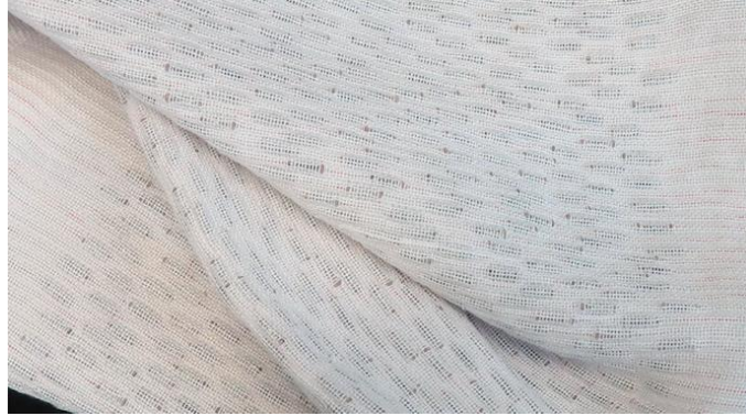
Şekil 3.1. Fotovoltaik hücreli tekstil kumaşı, Nottingham Trent üniversitesi, 2022
