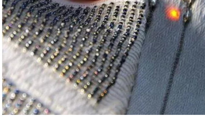
Şekil 3.5. Güneş ışığını elektrik enerjisine dönüştürebilen fotovoltaik hücreli tekstil.
