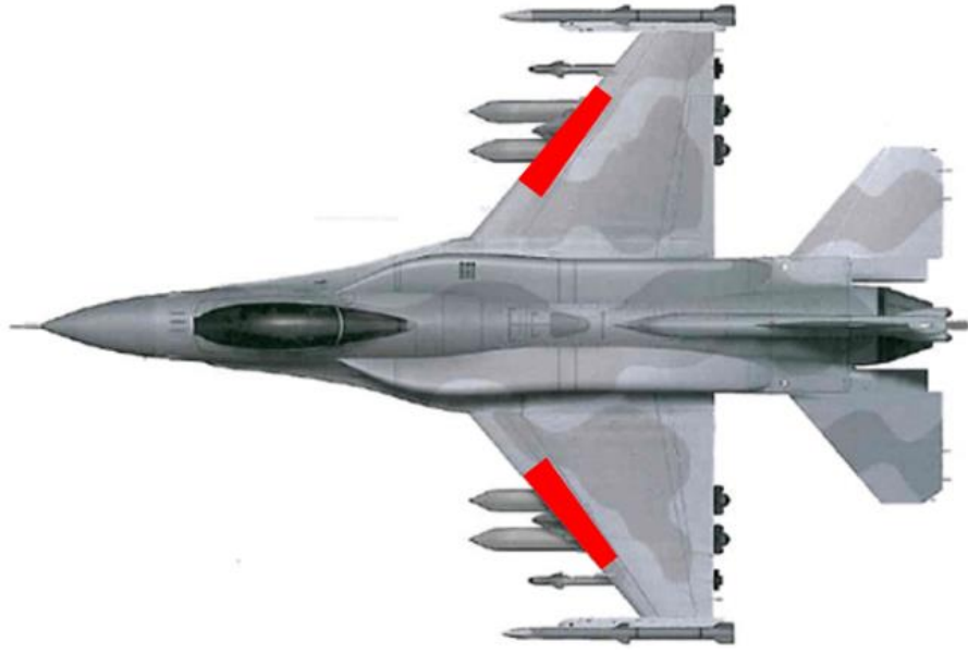
Şekil 6. 1. L-bant radarların kanatta yerleşim bölgeleri [40]
