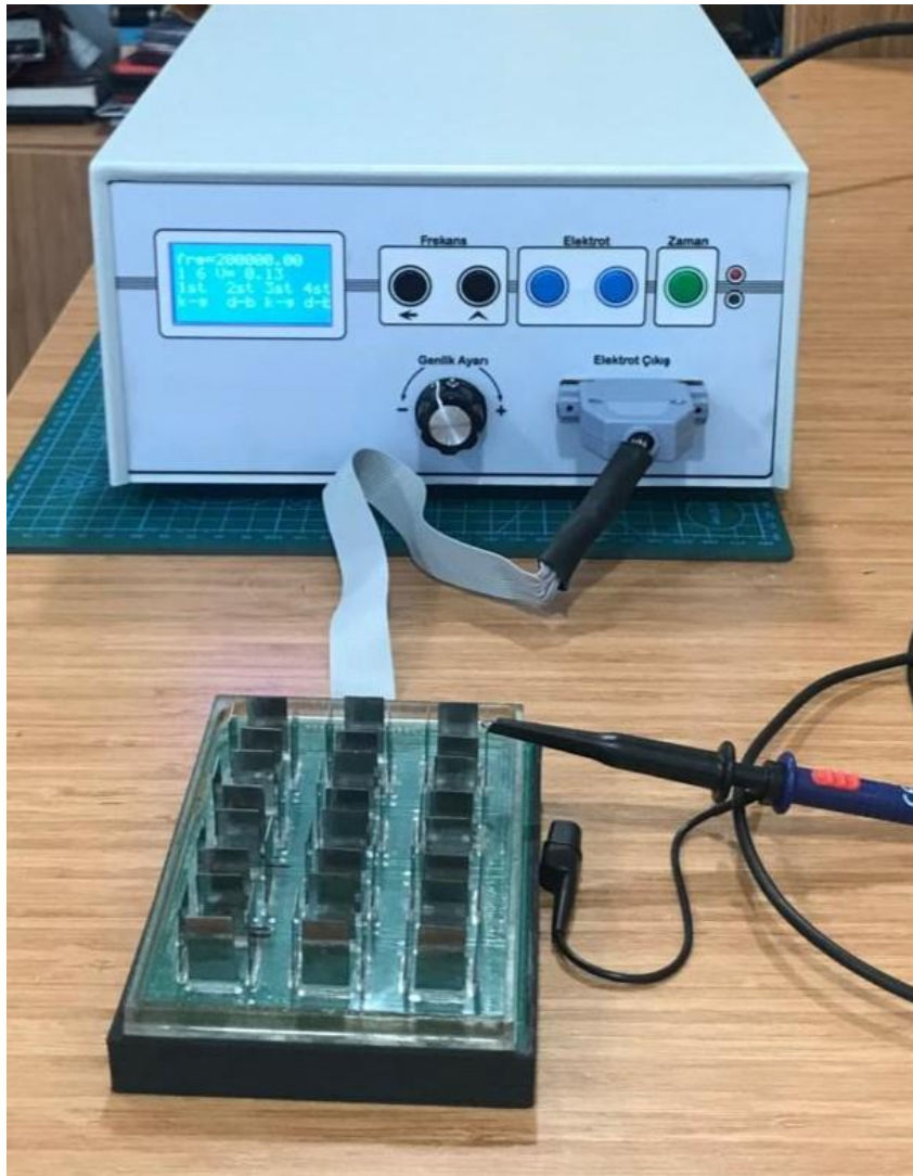
Şekil 4.7. Alternatif elektrik alan kaynağından elektro-kültür plakaya gelen sinyallerin doğruluk testleri.
