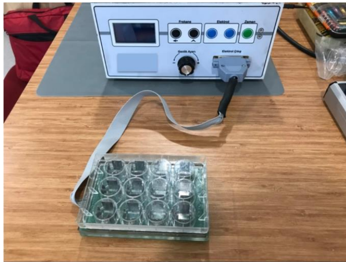
Şekil 4.6. Elektro-kültür plakanın, standart bir 12-kuyucuklu plakaya uygulanması sonrası elektrik alan kaynağına DB25 konnektörü ile bağlantısı.
