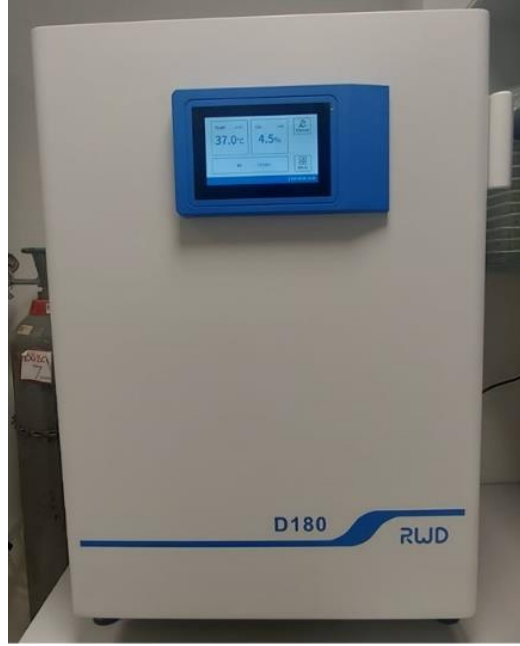
Şekil 3.19. Hücrelerin, 37°C, %5 CO 2 ve %95 nem ortamında inkübasyon işlemlerinin gerçekleştirildiği inkübatör (RWD-D180, Çin).
