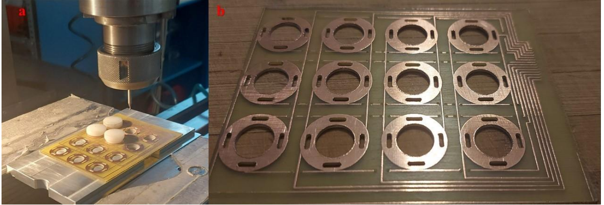
Şekil 3.11. (a) PCB'nin freze ile delinmesi, (b) elektronik kart tasarımının PCB'ye basıldıktan sonra, kartın nihai görünümü ve elektrot bağlantıları için açılan bağlantı noktaları.
