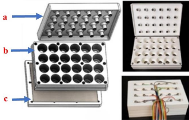
Şekil 2.6. Titanyum elektrotlardan oluşan elektro-kültür plaka, (a) kapak, (b) gövde ve (c) taban [38].
