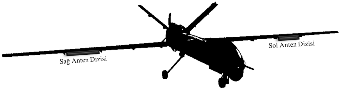
Şekil 2.1 Elektronik Harp Sisteminin Antenlerinin İHA Üzerindeki Konumları
