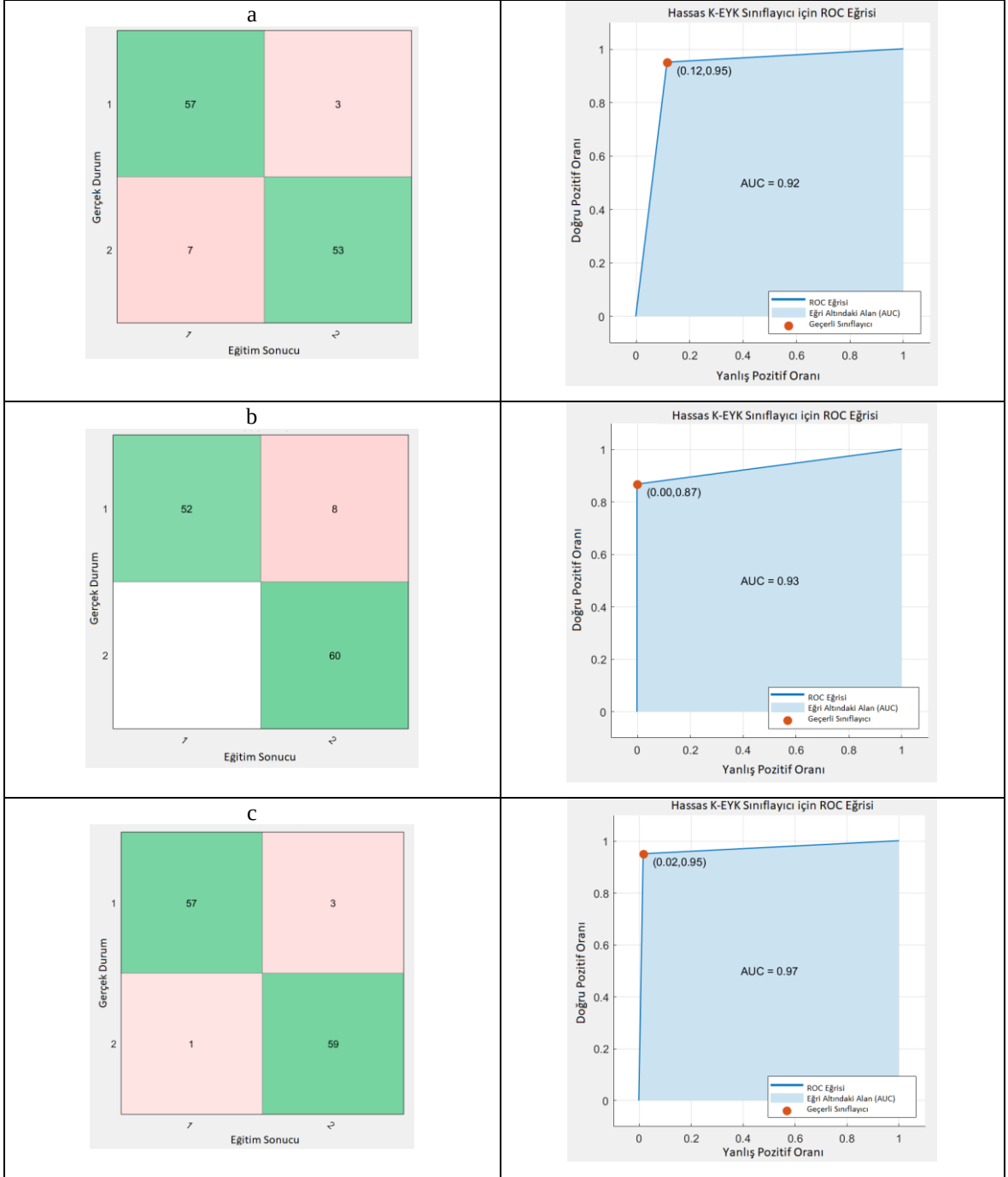
Şekil 4.5. Hassas K-EYK modelinin ünlü (a), ünsüz (b) ve tüm sesler (c) için eğitim sonuçlarına ait hata matrisleri ve ROC eğrileri.
