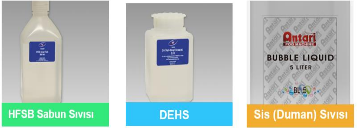
Şekil 3.2. Hava ortamında kullanılan farklı tip tohumlama partikülleri
