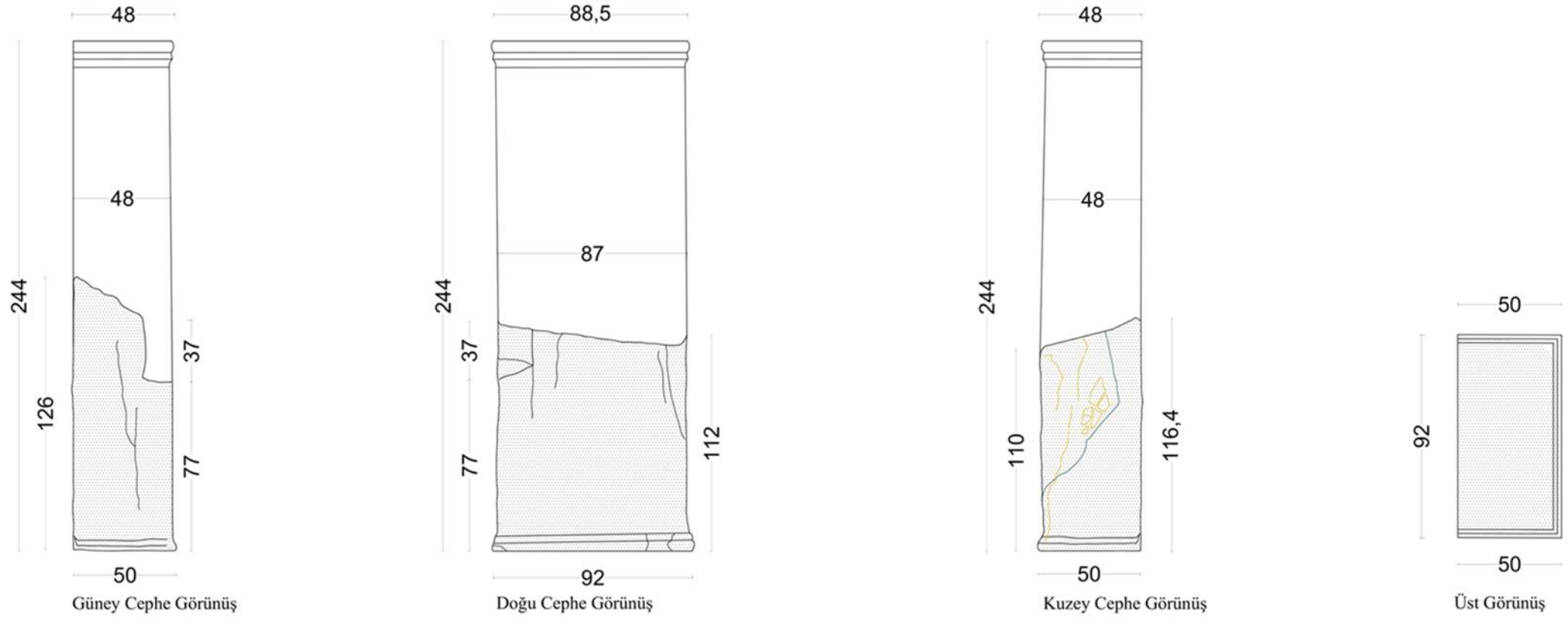
Şekil 4.4.2.4. Batı yan ayak bloğu üzerinde siyah ve beyaz birikme.
