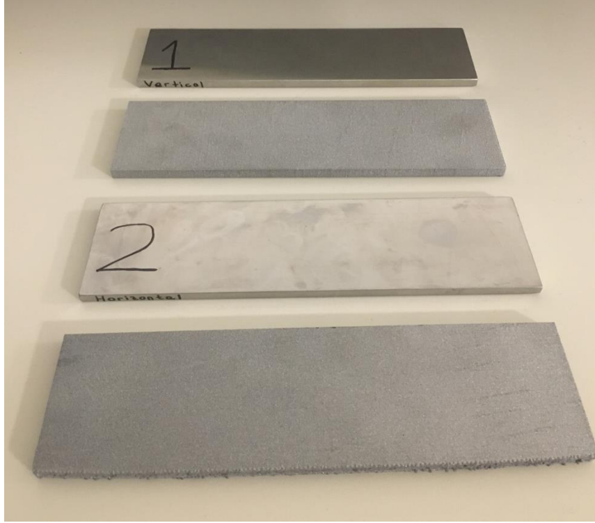
Şekil 4.7. Katmanlı imalat sonrası talaşlı işlem uygulanan numuneler ve talaşlı işlem uygulanmamış numuneler.(1 Numaralı numune : Dikey inşa yönünde üretilen numune, 2 Numaralı numune : Yatay inşa yönünde üretilen numune)
