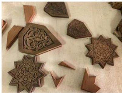
Şekil 5.1. Künde-kâri kapı göbeği iç dolgu parçaları (a) ve omurga çıtaları (b) (Gülizar Büşra Kılıç).
