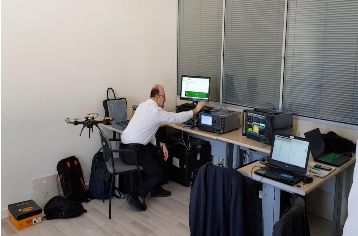
Şekil 7.28 C-Bant 5G YR İşareti İle Dron Tespiti Ölçümü a) Blok Şeması b) Düzenek
