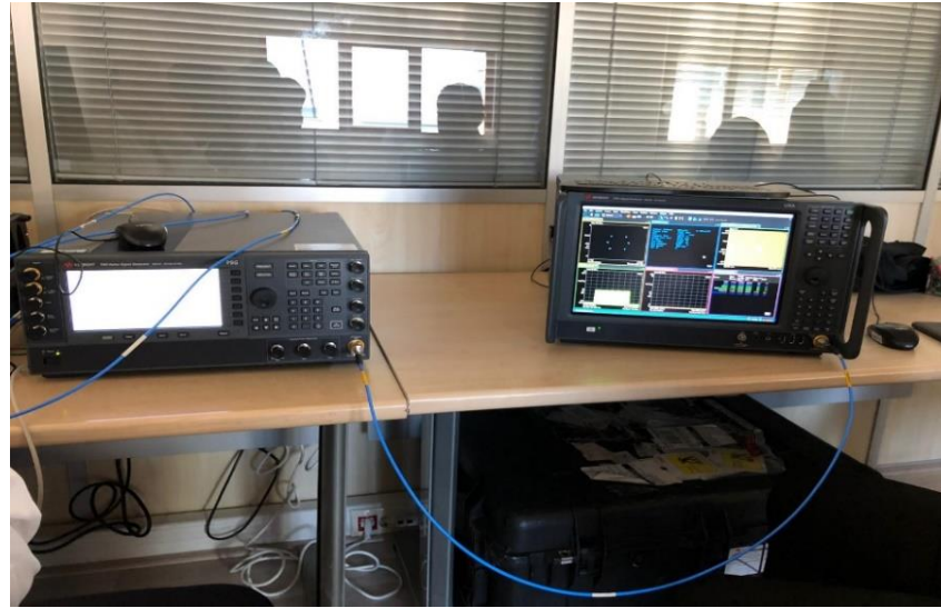
Şekil 7.26 Referans İşareti Ölçüm Düzenegi a) Blok Şeması b) Düzenek
