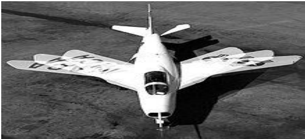
Şekil 3.2. Bell X-5 Ait farklı kanat süpürme açıları
