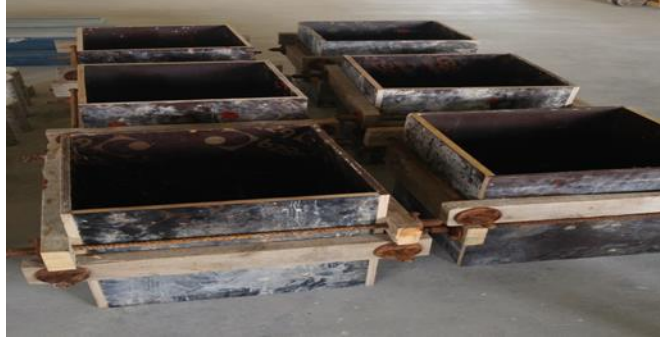
Şekil 4.3. Hedef betonu kalıpları görseli.
