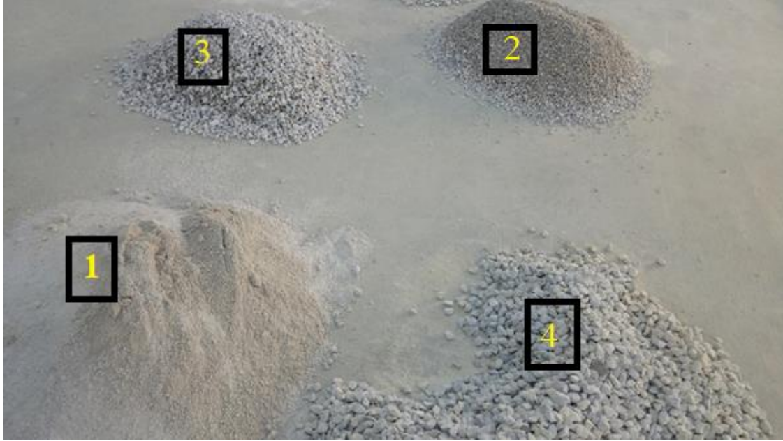
Şekil 2.2. (1) 0-5 mm kum, (2) 5-12 mm ince agrega, (3) 12-19 mm kaba agrega ve (4) 19-25 mm kaba agrega görseli.
