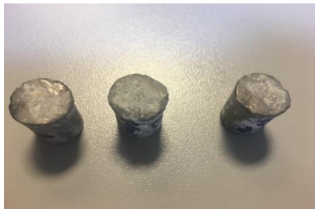
Şekil 4.12. Test sonrası tungsten delicinin hasar görüntüsü.
