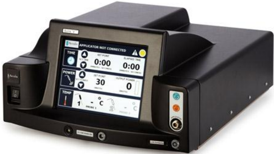
řekil 1.7. Mikrodalga ablyasyon cihazı.
