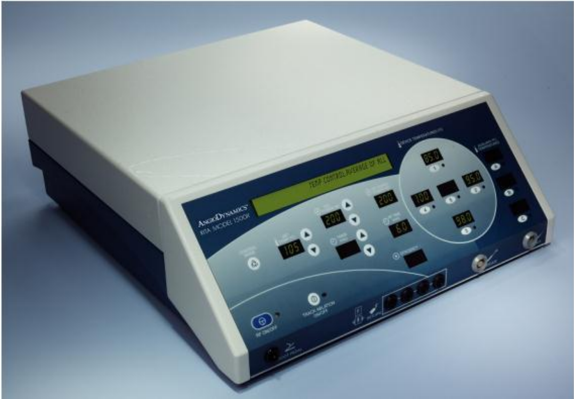
Şekil 1.6. Radyofrekans ablyasyon cihazı.
