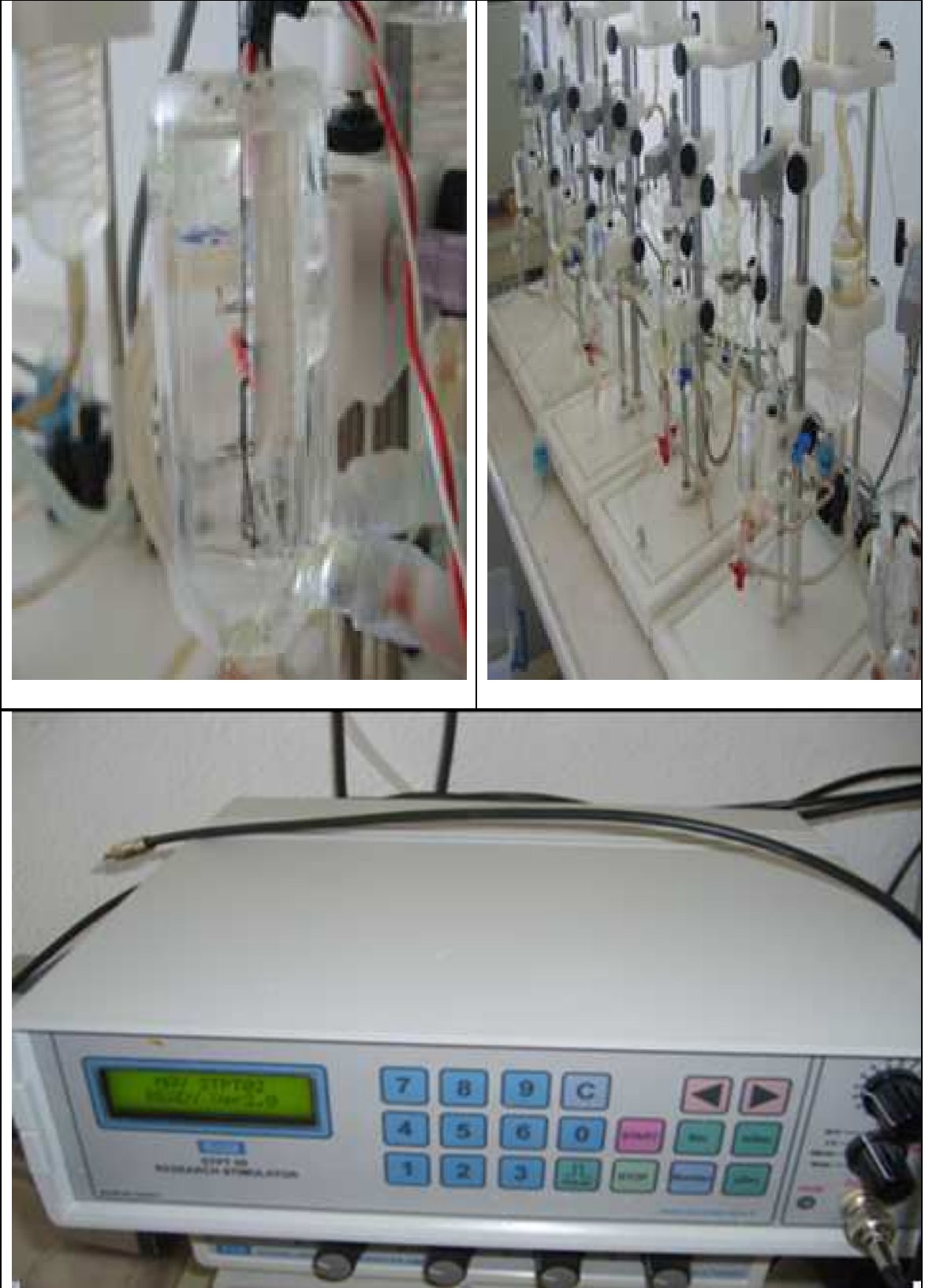
Şekil 3.5. Sağ üstte; izole organ banyosu sistemi, sol üstte; izole organ banyosunda mesane dokusu örneği, alttaki resim; EAU için kullanılan cihaz (MAY STPT05 Research Stimulator)
