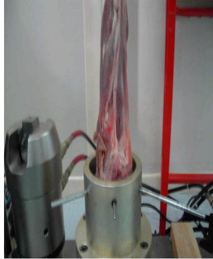
Resim 1d: İnstron cihazına tendonun bağlanması.
