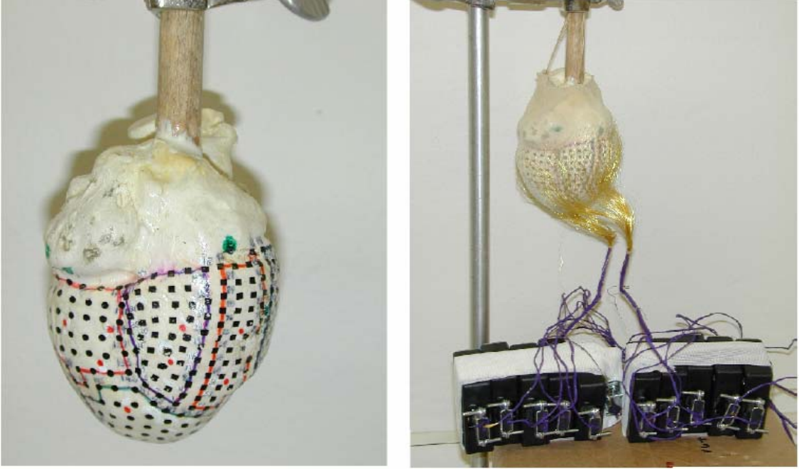
Şekil 3.2 490 elektrotla çevrili ventrikül geometrisi. Sol panel: Elektrotların kalp üzerindeki yerlerini göstermek üzere orta büyüklükteki bir köpek kalbi kullanılarak oluşturulmuş kalıbı. Sağ panel: 490 elektrotlu çorap dizisinin kalıp üzerinde yerleştirilmesi ve elektrot kablolarını veri toplama sistemine aktarmaya yarayan soketlerin beraber gösterimi. ([36]'dan alınmıştır)
