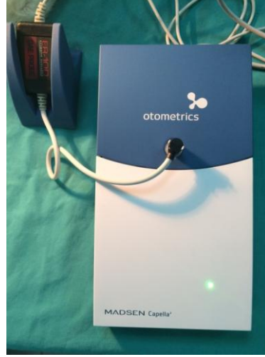
Resim 3.2. Madsen Capella 2 (GN Otometrics, Danimarka) OAE ölçüm cihazı
