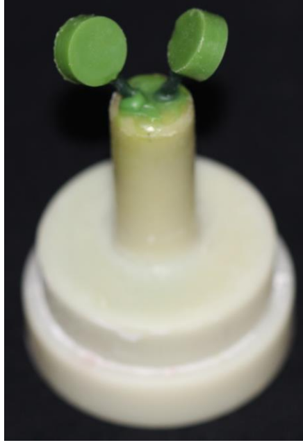
Şekil 3.5. IPS e.maxPress örneklerin presleme öncesi revetmana alınmış hali
