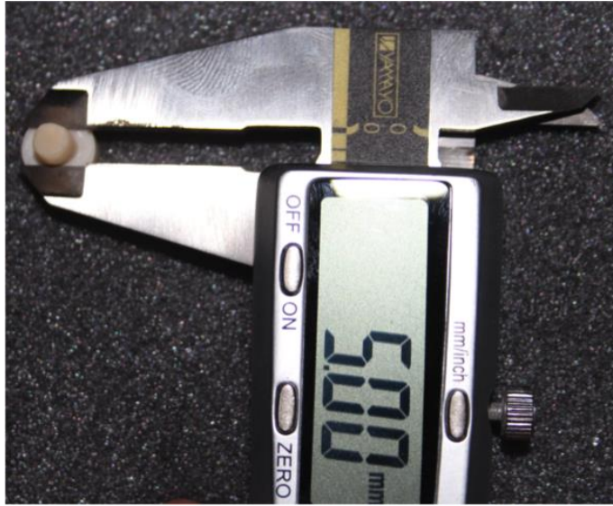
Şekil 3.12. Üst Yapı Seramik Kalınlığının Dijital Kumpas Yardımı ile Ölçülmesi
