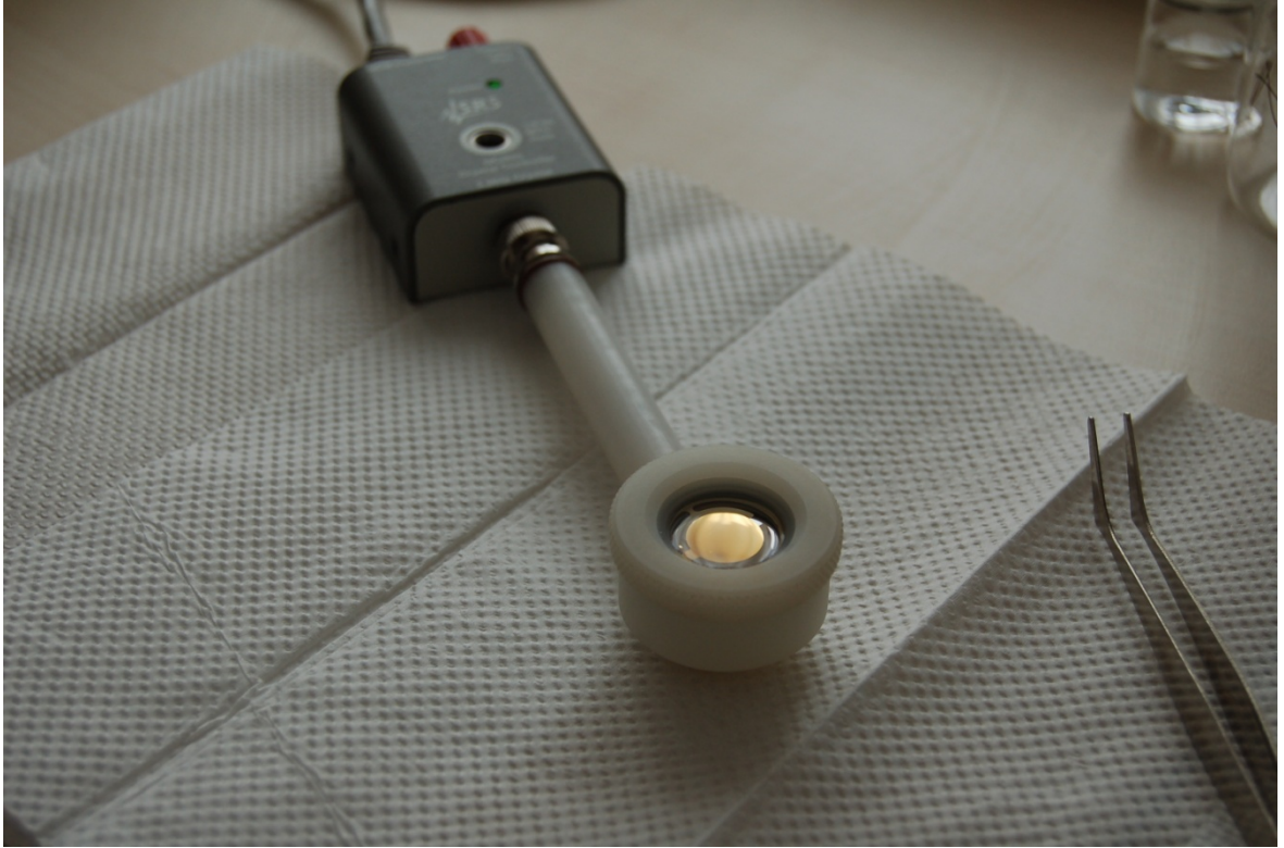
Şekil 3.5 QCM probunun yatay konumda kullanılması.
