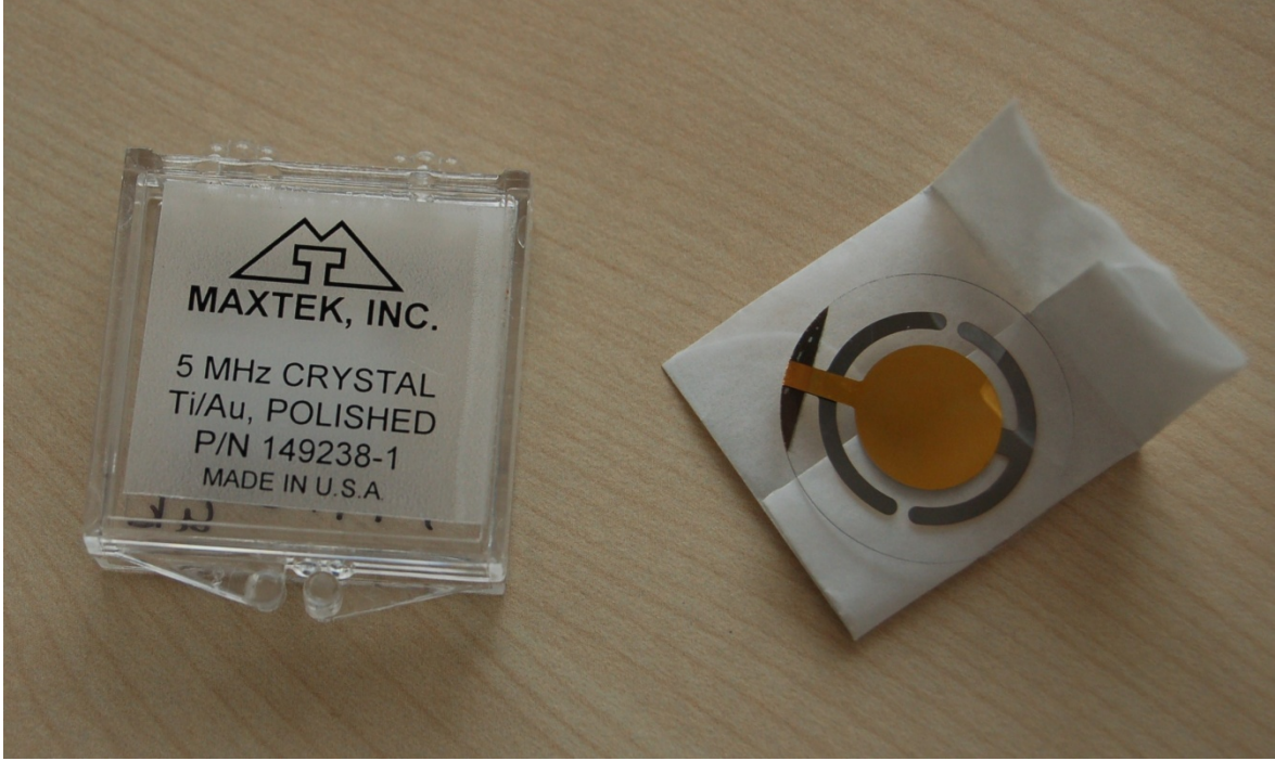
Şekil 3.1 5 MHz'lik Ti/Au alaşım elektrotlu quartz kristal.
