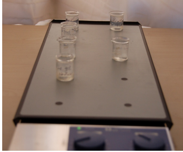
Şekil 3.2 Ksantan gam hidrojellerinin karıştırırmalı ortamda hazırlanışı.
