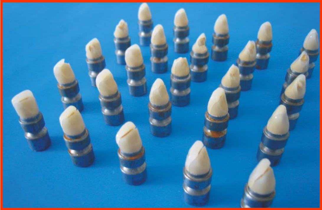
Şekil 4.12 : Yüklemeden sonra Galvano-seramik örneklerde oluşan deformasyonların görüntüsü
