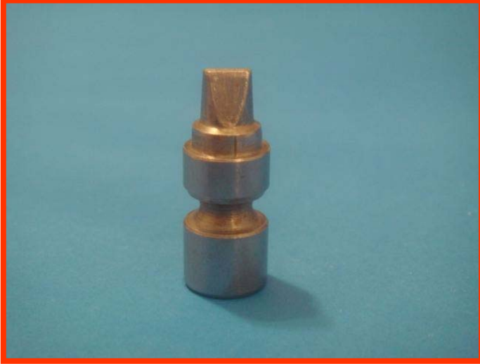
Şekil 3.1. Kesilmiş santral diş şeklinde üretilen paslanmaz çelik day
