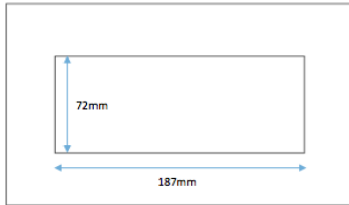
Şekil 3.2 DSA' nın yerleştirildiği boşluklu PMMA yüzeyi
