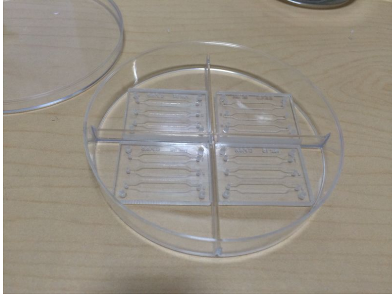
Şekil 3.8 Yüzey kimyası uygun hale getirilen çipler
