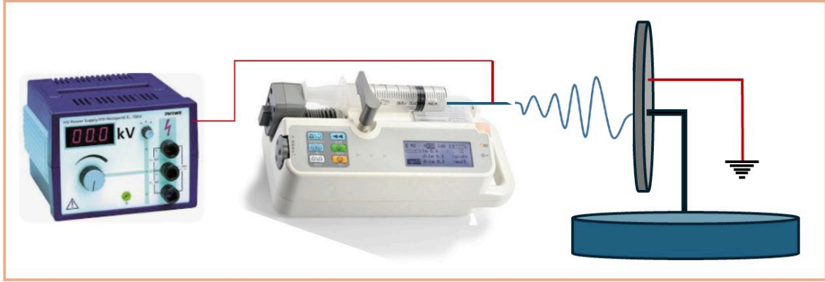
Şekil 3.2. Elektroğirme sistemi düzeneğinin şematik görünümü
