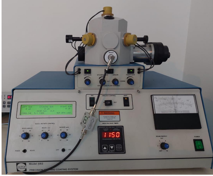
Şekil 3.14. Numunenin SEM ölçümleri alınmadan önce kaplanması için kullanılan PECS Gatan model 682 marka model cihaz
