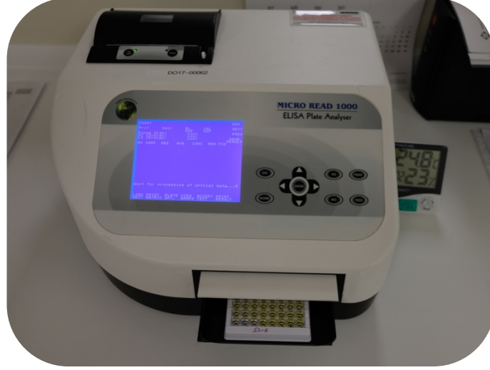
Şekil 5. ELISA plağının GENTAUR MICRO READ 1000 cihazı ile 450 nm’de okunması
