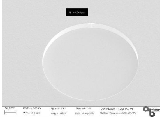
Şekil 2.39. Elektroliz yöntemi ile nikel maske kaplama adımı sonrası SiC alttaş yüzeyin SEM görüntüsü
