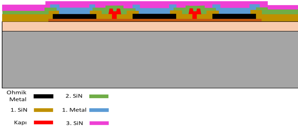
Şekil 2.22. Üçüncü Silisyum Nitrür ( \text{Si}_3\text{N}_4 ) tabakasının kaplandığı süreç adımı sonrası wafer kesit görüntüsü
