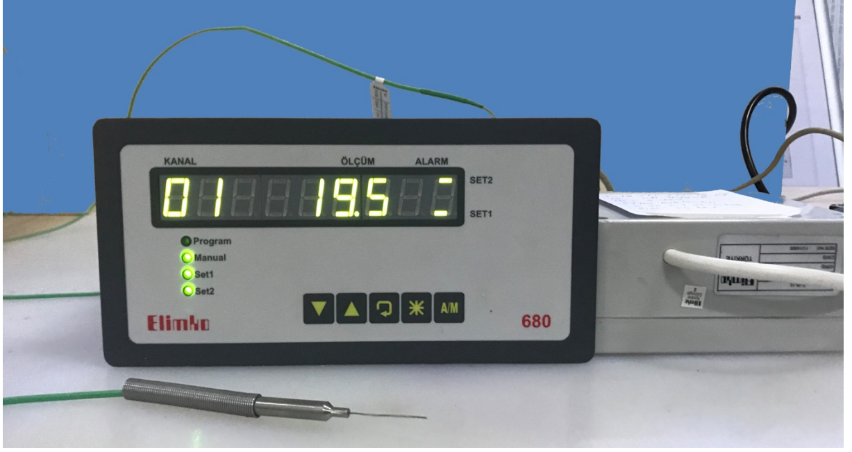
Şekil 20. Elimko marka E-680 serisi “Data-Logger” (Türkiye), Elimko marka iletişim birimi (Türkiye), Elimko marka K tipi termokupl (Türkiye)
