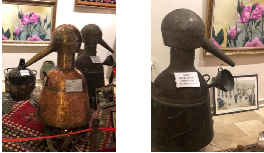
Resim 2. Gül Yağı Üretimindeki İmbikler (Budak, 2021)
