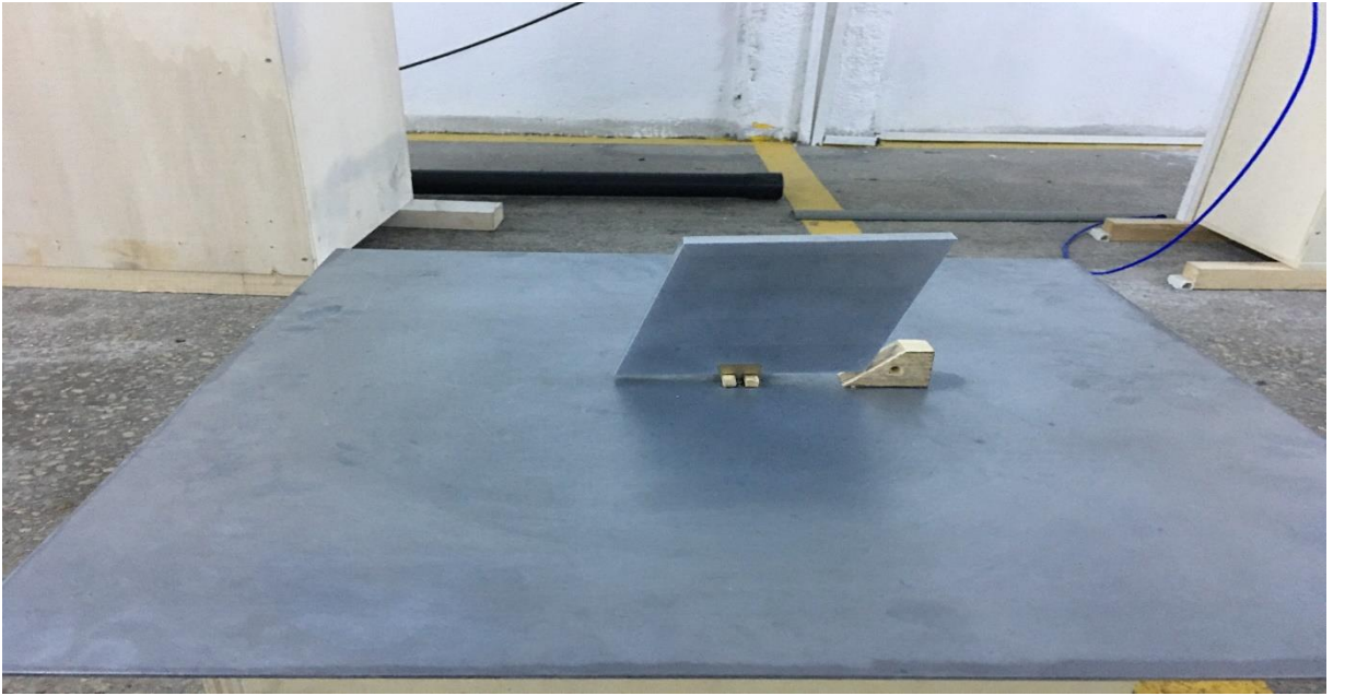
Şekil 3.67 Üretilen Düz Bıçak Anten Ölçüm Düzeneği
