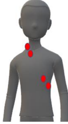
Şekil 2.11 Tetrapolar Ag/AgCl jel elektrot konfigürasyonu [25]
