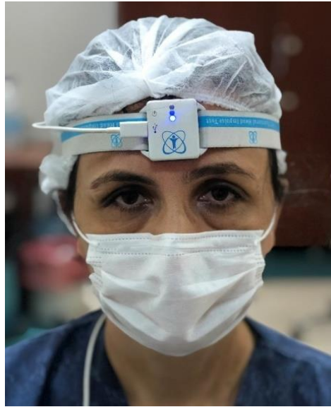
Şekil 3.8. Başın açılmal hızı ve yönünü algılayıp ölçen jiroskopun (baş bandı sensörü) hastanın alnının tam ortasına yerleştirilme şekli
