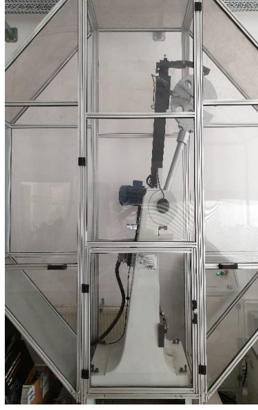
Şekil 3.9 Alşa A-02-T Çentik Darbe Test Cihazı
