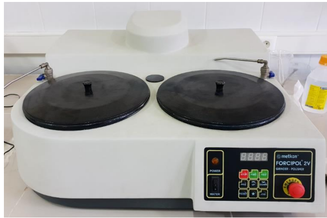
Şekil 3.4 Yüzey Hazırlamada Kullanılan Zımpara Cihazı
