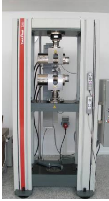
Şekil 3.7 Çekme Test Cihazı (250kN)
