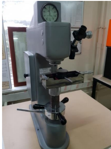
Şekil 3.10 BMS 200RB Sertlik Ölçüm Cihazı
