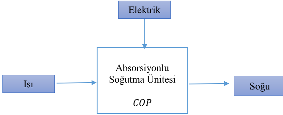
Şekil 2.6 Absorpsiyonlu soğutma sistemi kara kutu gösterimi
