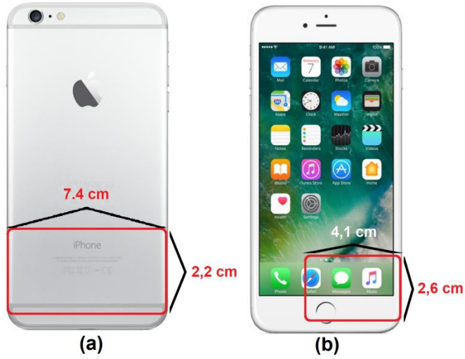
Şekil 3.20 İPhone 6 Plus hoparlör kısmı taranan bölgeler a) arka b) ön yüzler
