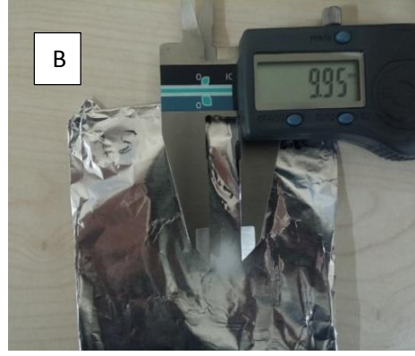
Şekil 3.9 Çift silindirik elektrotlu düzenekte voltajın fiber dağılım çapına etkisi
