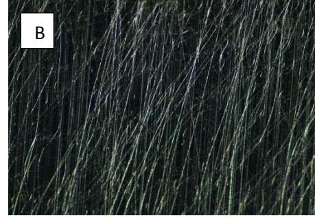
Şekil 11 İğne ucuna uygulanan voltaj(4.9 kV) ve süre(10 sn) sabitken frekansın etkisi A) 5 kHz B) 10 kHz
