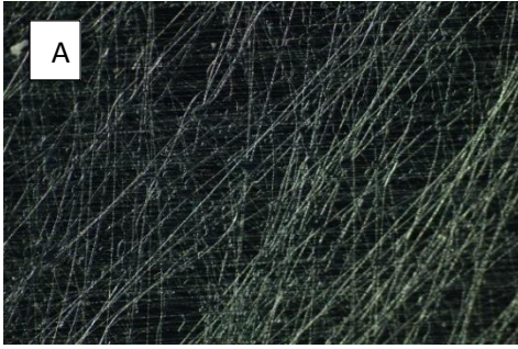
Şekil 11 İğne ucuna uygulanan voltaj(4.9 kV) ve süre(10 sn) sabitken frekansın etkisi A) 5 kHz B) 10 kHz
