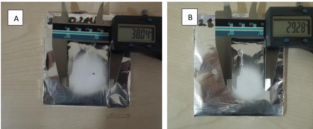
Şekil 3.7 Silindirik elektrot kullanmadan oluşan nanofiber yayılım çapları
