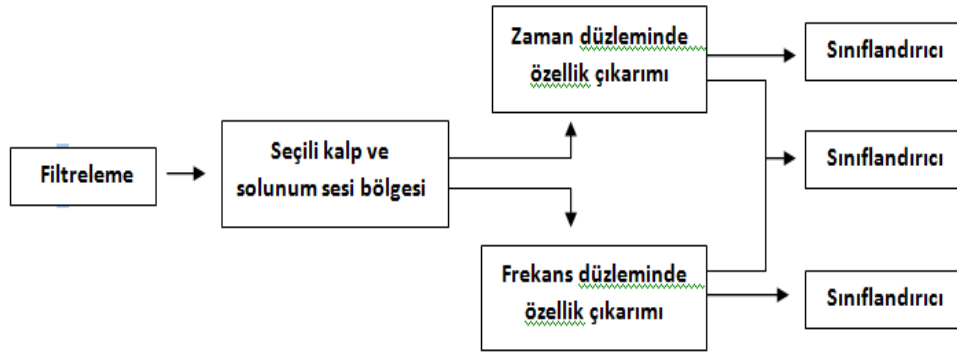
Şekil 3.3 Kalp ve solunum seslerinden özellik çıkarımı ile ilgili blok diyagramı
