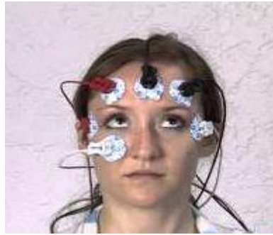
Şekil 3.2 Yatay ve düşey göz hareketlerinin algılanması için yapılan elektrot bağlantı şekli [36]
